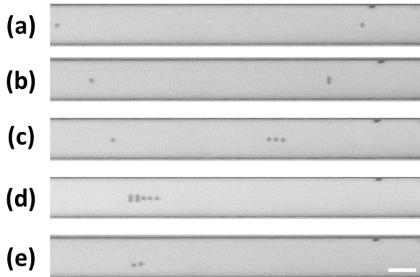
Figure 62. Images au microscopes optique de gouttes observées vers l'extrémité du capillaire de D=150\mu\text{m} (à 63cm de la jonction en T) avec k=40 . Echelle : 100\mu\text{m} .
