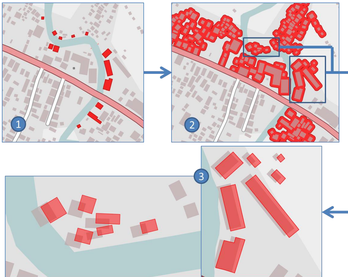
Figure 2-14 (1) détection des incohérences de LoD, ici des bâtiments peu détaillés chevauchant la rivière. (2) des groupes de bâtiments proches sont créés autour des incohérences identifiées. (3) chaque groupe est harmonisé d'un bloc en enlevant le chevauchement sans en créer de nouveaux avec les bâtiments voisins (bâtiments harmonisés en rouge) (@OpenStreetMap contributors).
