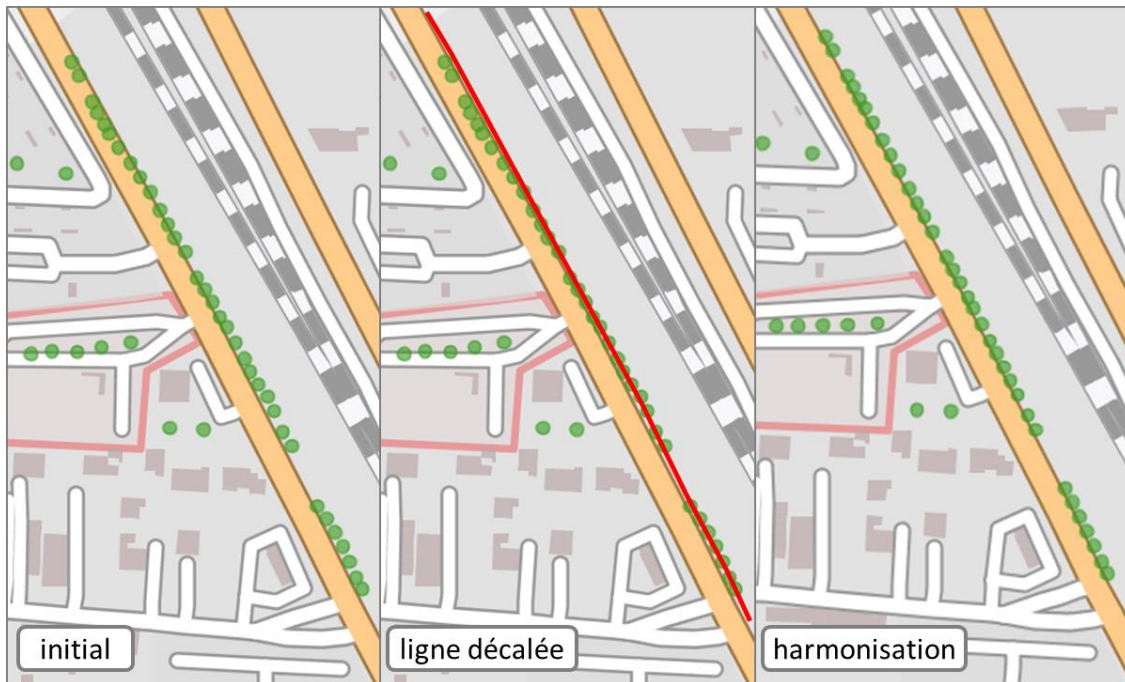
Figure 2-12 Les arbres peu détaillés sont correctement alignés le long de la route en les projetant sur une ligne décalée de la route (@OpenStreetMap contributors).
