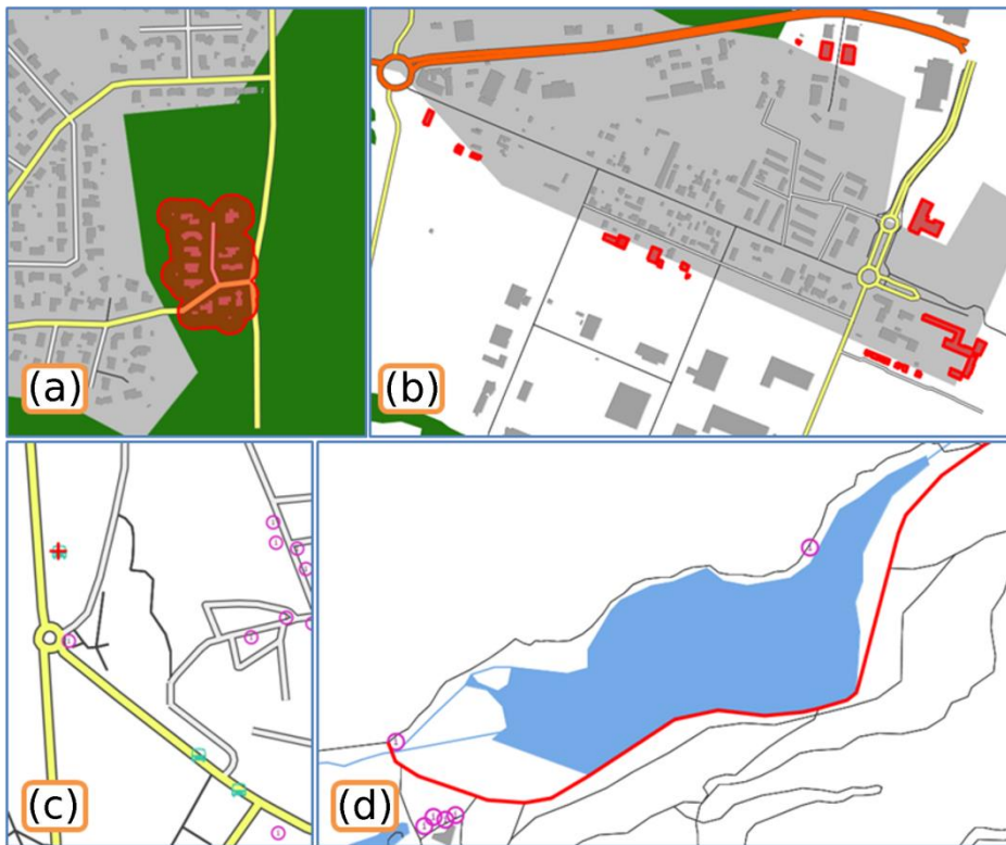
Figure 2-8 Détection automatique de relations spatiales improbables entre objets de LoD différent : (a) ce groupe de bâtiments proches ne peut pas être dans une forêt, (b) la zone bâtie grise devrait inclure les bâtiments en rouge, (c) l'arrêt de bus marqué d'une croix rouge est trop loin de la route, (d) le chemin rouge passe dans le lac (@OpenStreetMap contributors).
