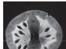
Figure 47 : Image RARE T2 d'une tomate cerise obtenue avec le banc présenté Figure 46.
