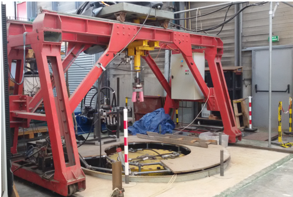
FIGURE 2.8 – Grande chambre de calibration du laboratoire 3SR (au sol) et son bâti de chargement.
