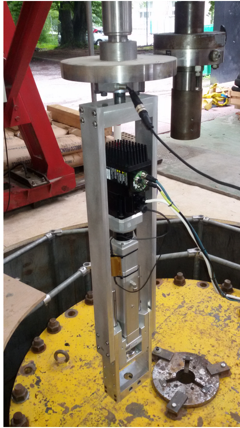
FIGURE 2.6 – Prototype du module de chargement cyclique (situé en tête du train de tiges) utilisé pendant les essais en chambre de calibration au laboratoire 3SR (archive Equaterre ).
