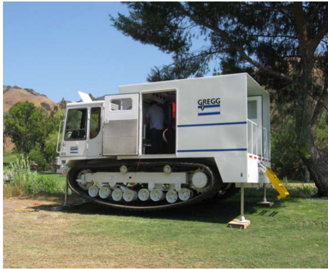
FIGURE 1.7 – Exemple d'un dispositif de fonçage pour CPT Robertson and Cabal (2010).
