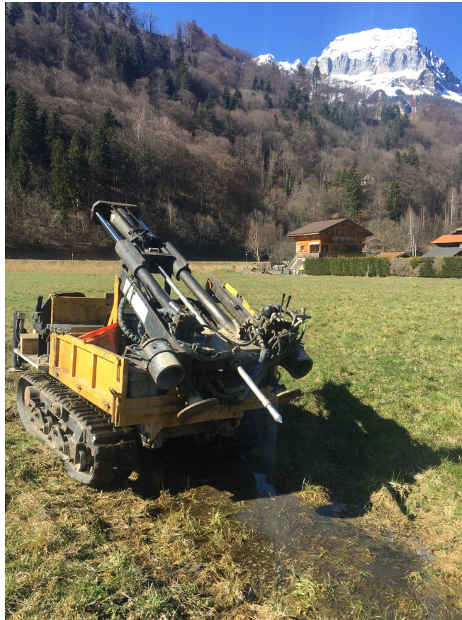
FIGURE 2.3 – La pointe mécanique type Gouda montée sur un chenillard (archive Equaterre ).
