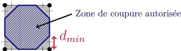
FIGURE 3.5.6: Localisation possible de la discontinuité dans une maille à rompre. Une distance  $d_{min}$  est imposée entre la discontinuité et les noeuds
