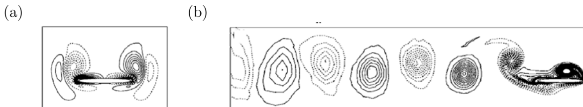
FIGURE 5.4 – Champ de vorticit  pour (a) le r gime sym trique (non-propulsif) et (b) le r gime asym trique (propulsif) [132].
