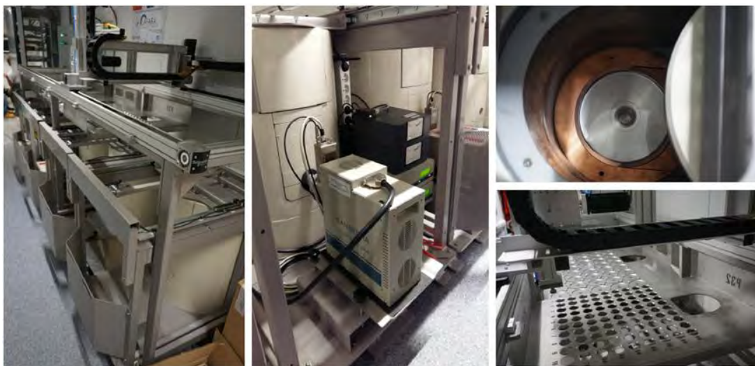
Figure 3.7 : Spectromètres gamma bas-bruit et leurs équipements (passeur automatique, cryogénérateur, château de plomb et magasins) installés au LAFARA
