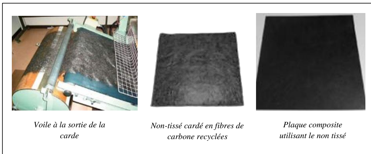
Figure 1. 13: Etapes de transformation des fibres de carbone recyclées en composite 2 nd génération Hitachi Chemical Technical Report No.56 [44]
