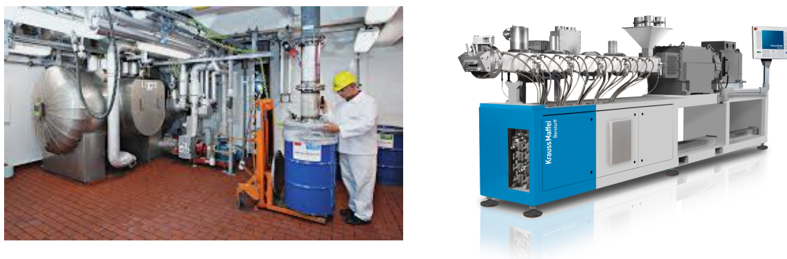
Figure 1-25 : Production de MOFs de manière solvothermale à BASF (gauche) et par mécano-chimie chez MOF Technologies (droite)
