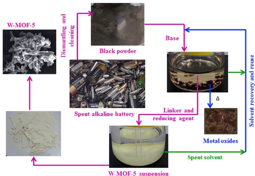
Figure 3-5 : Schéma de la méthode de recyclage par précipitation de MOF (©2018, Elsevier)
