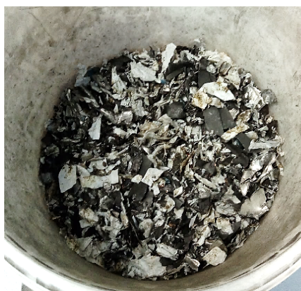
Figure 3-6 : Déchets de batteries broyées et composition approximative fournie
