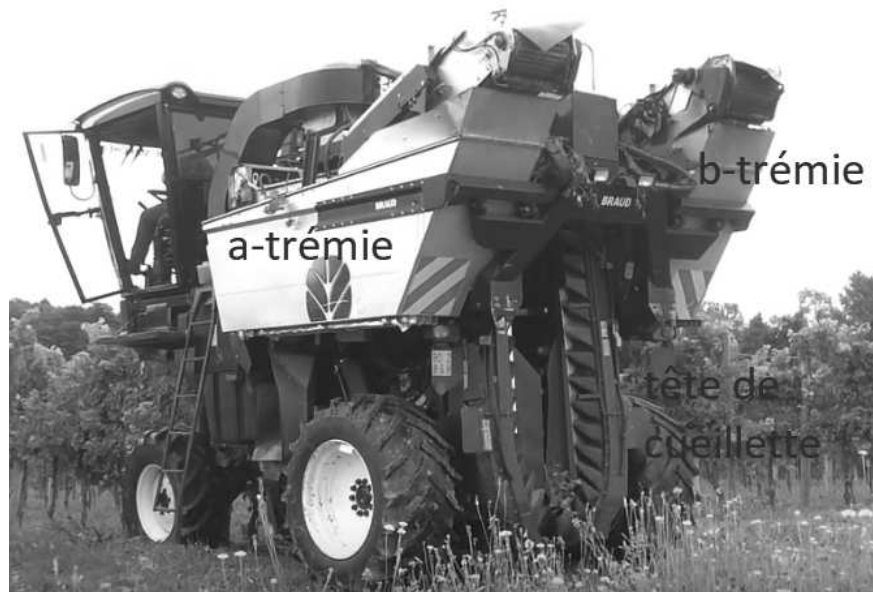
FIGURE 5.1 – Vue d'ensemble de la machine pendant la récolte
