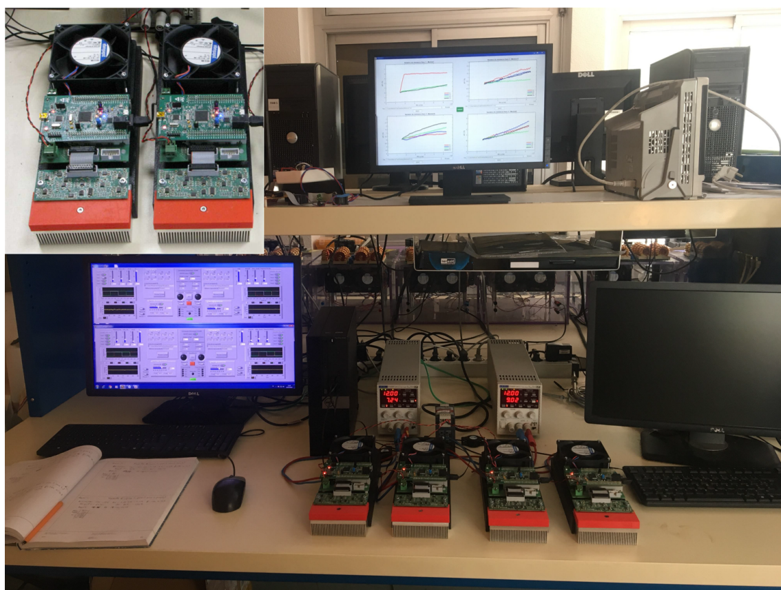
FIGURE 2.37: Plateforme de test pour le vieillissement des échantillons.
