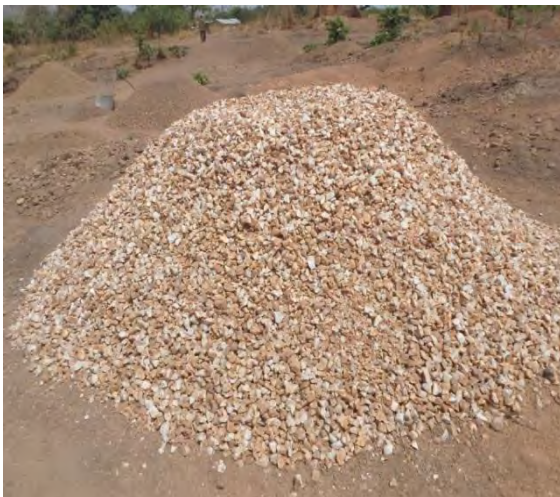
Photo 13 : Blocs de pierres concassés sous forme de gravier à Ouroubona
