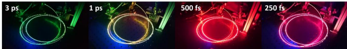
Figure 81 : Le spectre étant très dépendant des conditions expérimentales, la fibre s'illumine elle-même de couleurs différentes lorsque ces conditions changent. La puissance d'entrée dans la fibre est de 3 W.
