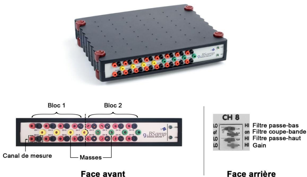
Figure 3.2 : L'amplificateur g.BSamp. Photographie de l'amplificateur avec une vue détaillée de sa face avant, ainsi qu'une vue des différents traitements analogiques accessibles en face arrière pour chaque canal de mesure.
