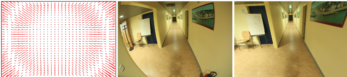
FIGURE C.1 – La correction de distorsion d'une image prise par l'objectif Fisheye. Gauche : les vecteurs du résidu de calibration, Milieu : image originale, Droite : image corrigée.
