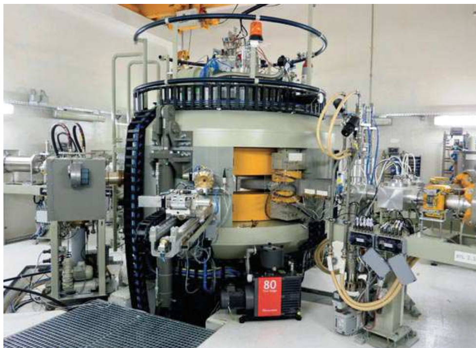
FIGURE 1.2 – Exemple de cyclotron à usage médical. Image extraite des courriers du CERN.
