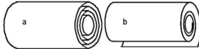
Figure 9 : Faisceau de nanotubes de carbone multi-feuillets : (a) formé de feuillets de graphène arrangés en cylindres concentriques ; (b) formé de feuillets de graphène arrangés enroulés en spirale
