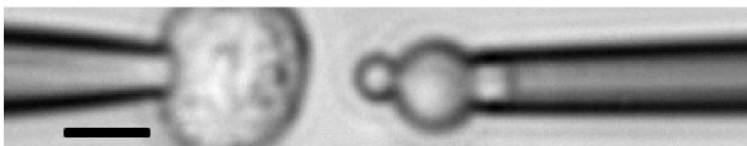
Fig. II.11 Situation observable au microscope avant le début des mesures en BFP. On trouve à gauche la cellule tenue par une pipette et à droite la sonde de force composée de la bille et du globule rouge légèrement aspiré par la pipette de droite. L'ensemble est volontairement défocalisé pour repérer plus précisément la position de la bille. La barre d'échelle correspond à 5 \mu\text{m}
