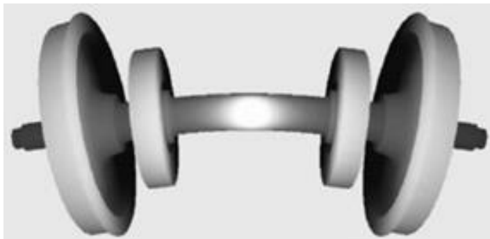
Figure 1.24 – Mode de vibration de l'essieu en flexion [17]
