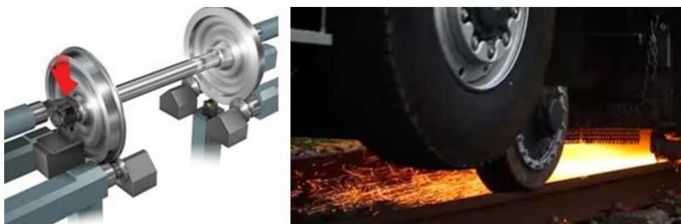
Figure 2.1 – Reprofilage des roues et meulage des rails [62]
