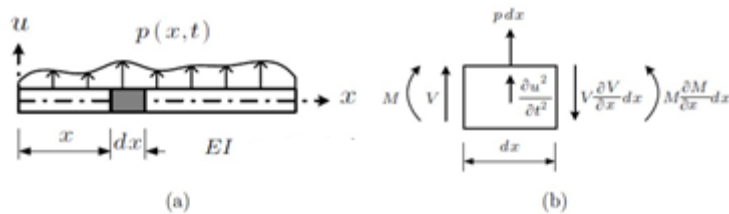
Figure 1.4 – Modélisation du rail par poutre [6]
