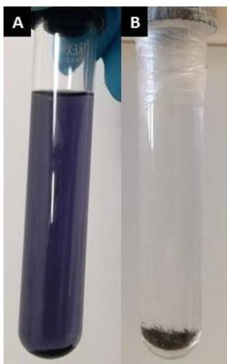
Figure I-37 : Comparaison des surnageants après centrifugation dans EtOH après 1 h de réaction (A) et 9 h (B).
