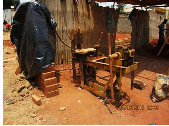
Étape 4 : Pressage de la terre grâce à une presse Terstaram (d)
