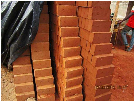
Étape 5 : Les briques de terre entreposées sèchent 3 jours en cuve humide, puis 3 semaines en cuve sèche. Elles sont protégées par des bâches des intempéries et d'un séchage trop brusque. (e)
