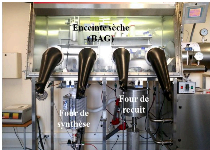
Figure 3-2 : Photographie de la boîte à gants
