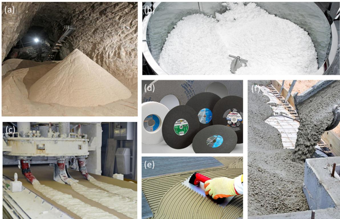
Fig. 1.1 Divers exemples de matériaux issus d'un procédé de mélange entre un matériau granulaire et un liquide : (a) Poudre de gypse après broyage, carrière de Cormeilles-en-Parisis, France. (b) Granulation humide de poudres en industrie pharmaceutique. (c) Mélangeur de la ligne de fabrication de plaques de plâtre (Placoplatre, Vaujours). (d) Abrasifs agglomérés (Saint-Gobain Abrasives). (e) Colle à carrelage (Weber). (f) Béton frais en cours d'étalement.
