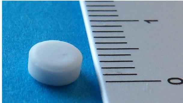
Figure 10 Dosimètre alanine utilisé en spectroscopie RPE. Image : IRSN.
