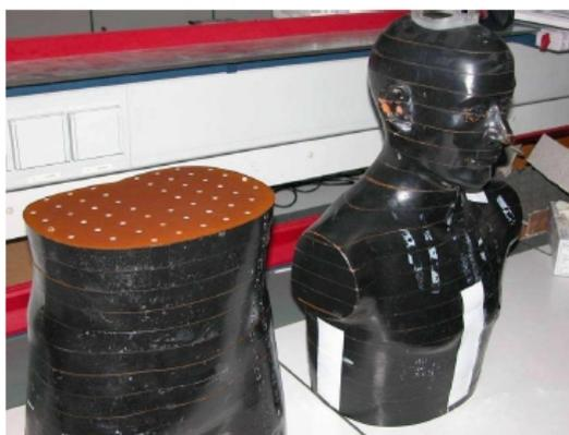
Figure 6 Fantôme anthropomorphe équivalent tissu de type Alderson Rando. Ce fantôme est constitué de tranches et peut être rempli de dosimètres thermoluminescents (TLD) ou radio-photoluminescents (RPL) permettant une cartographie de la dose. Image : IRSN.
