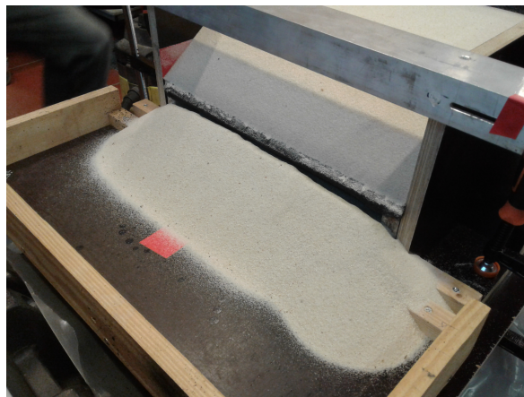
FIGURE 3.31 – Photo de la pente de talus naturel après avoir retiré la planche de l'ouverture de la maquette : le résultat n'est pas influencé par le sable qui s'est écoulé.
