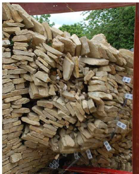
FIGURE 1.16 – Rupture tridimensionnelle vraie d'un MSPS [MUNDELL, 2009].
