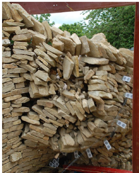
FIGURE 1.16 – Rupture tridimensionnelle vraie d'un MSPS [MUNDELL, 2009].
