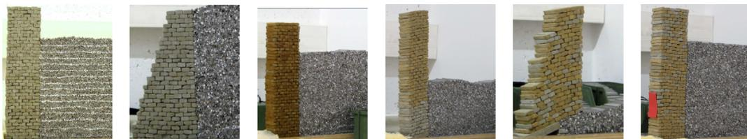
FIGURE 1.19 – Étude à échelle réduite de l'influence de différents paramètres (géométrie, clouage, jointoie-ment) [TERRADE, 2017].
