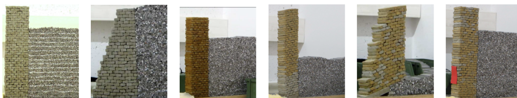
FIGURE 1.19 – Étude à échelle réduite de l'influence de différents paramètres (géométrie, clouage, jointoie-ment) [TERRADE, 2017].
