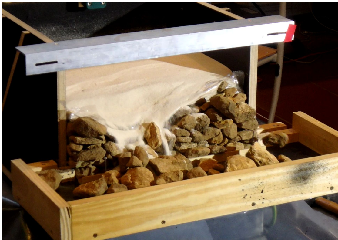
FIGURE A.12 – Photo de la rupture du second MSPS : des pierres des lits supérieurs sont déjà tombées, tout comme une partie centrale du mur tombée en renversement.
