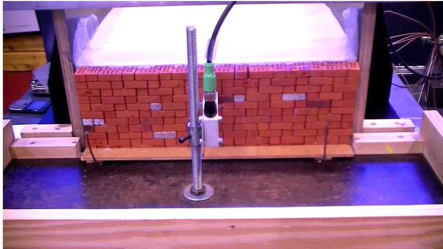
FIGURE 3.24 – Photo de la maquette de mur de soutènement expérimental posée sur la table vibrante. Le capteur pointe sur l'avant dernier lit de briques.
