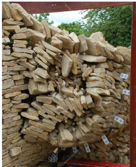
FIGURE 1.16 – Rupture tridimensionnelle vraie d'un MSPS [MUNDELL, 2009].
