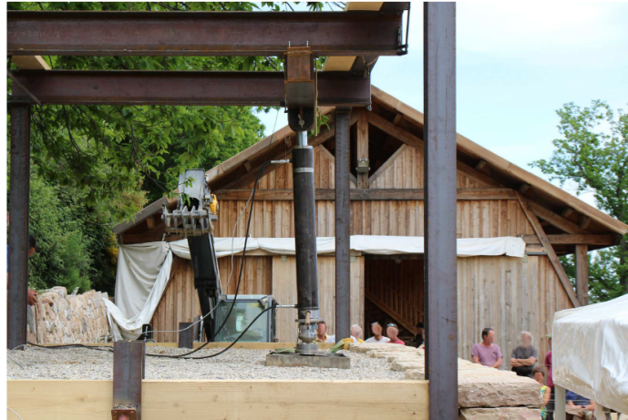
FIGURE 1.17 – Dispositif expérimental de TERRADE [2017], avec notamment le vérin hydraulique.
