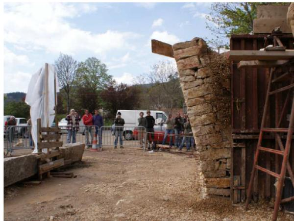
FIGURE 1.14 – Photographie de la rupture en renversement d'un MSPS testé par COLAS [2009].
