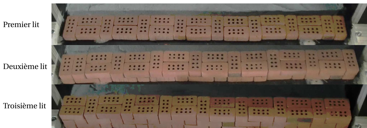
FIGURE A.6 – Schéma de l'assemblage utilisé pour les murs de largeur B = 3,4\text{cm} : vue du dessus. Le quatrième lit est identique au premier et ainsi de suite.
