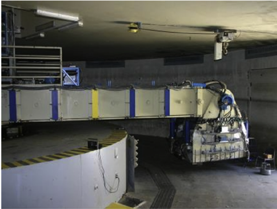
FIGURE 2.12 – Photo d'un dispositif expérimental utilisant une centrifugeuse [CANDIA et collab., 2016]. On voit le bras tournant de la centrifugeuse avec le modèle testé à son extrémité.
