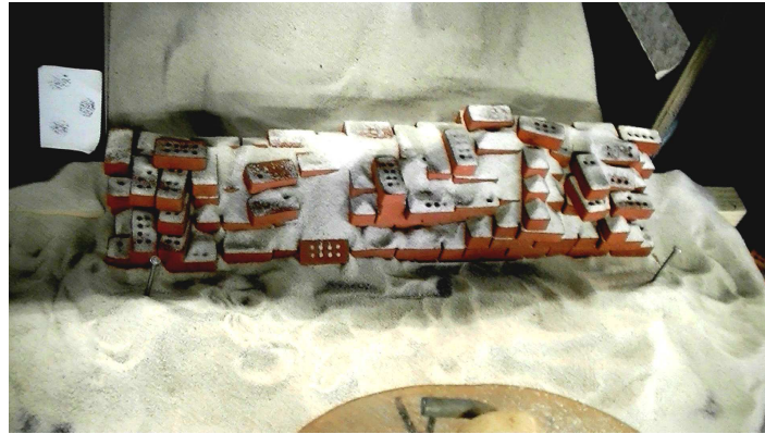
FIGURE 3.6 – Photo prise à la fin d'un essai d'inclinaison, après avoir enlevé le sable et les briques déplacées au cours de la rupture.
