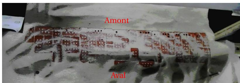
FIGURE 4.12 – Rupture mixte d'un mur expérimental de largeur  $B = 68\text{mm}$  : un glissement s'opère à la base du mur, sur la partie amont tandis que les briques du parement aval montrent une rupture en renversement (elles sont pour la plupart absentes ou déplacées).
