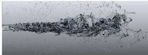
(c) Simulation DNS de l'atomisation d'un jet d'eau dans l'air [12] - L'injection se fait de gauche à droite
