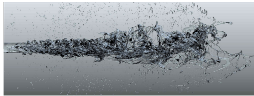
(c) Simulation DNS de l'atomisation d'un jet d'eau dans l'air [12] - L'injection se fait de gauche à droite
