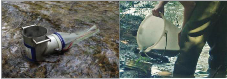
Figure 2.4. Échantillonnage des invertébrés : benthomètre (gauche) et passage au tamis (droite).
