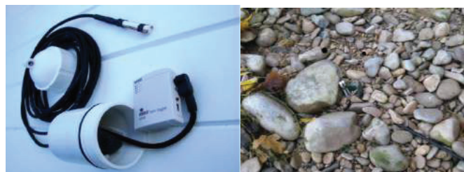
Figure 2.3. Composition du capteur (gauche) et positionnement de la sonde au fond du lit de la rivière (droite). (Photos : B. Launay)
