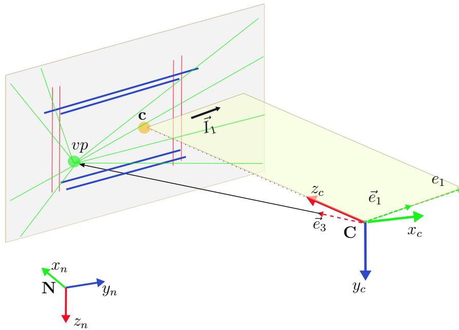
Figure 6 – Estimation de point de fuite infini, lignes horizontales.
