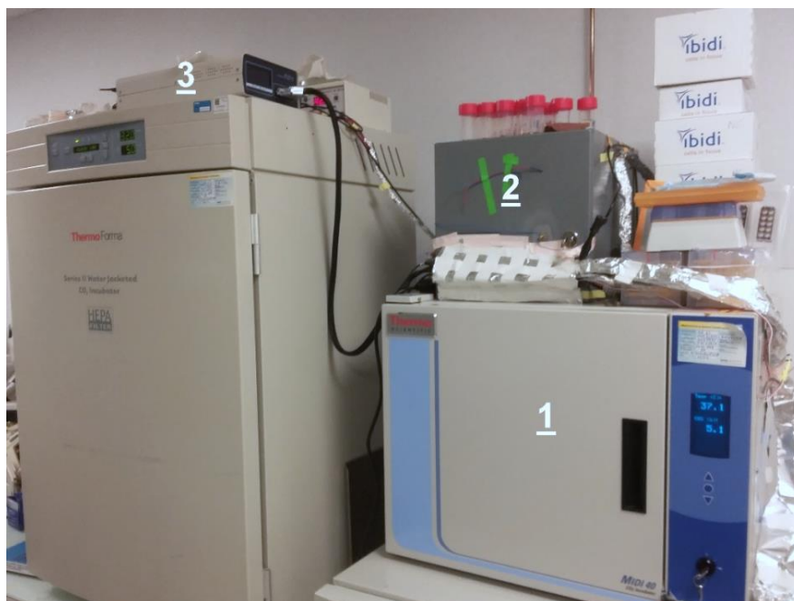
Figure 34 Incubateur (1) Cage de Faraday avec relais et Raspberry Pi (2) Potentiostat (3)
