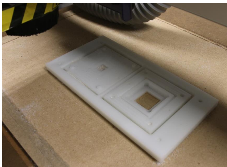
Figure 61 Support en polyéthylène en cours de fraisage.
