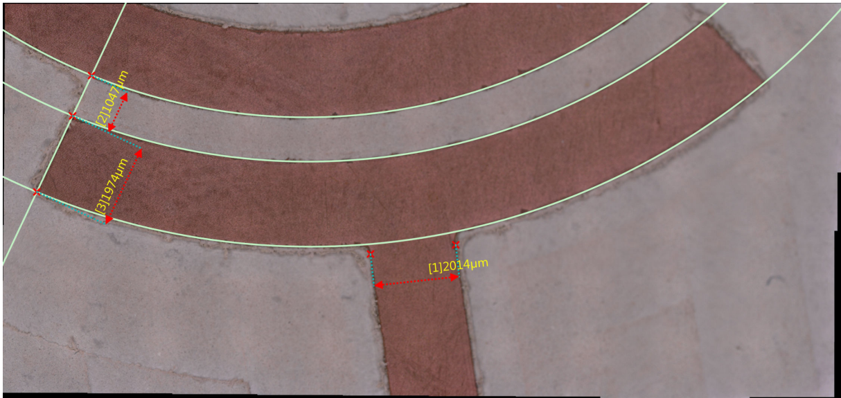
Figure 102 : Mesure dimensionnelle sur le plan (X, Y) du prototype de 0,635 mm d'épaisseur.
