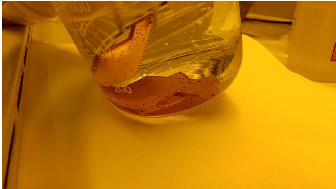
Figure 70 : Pièces obtenues après un dépôt autocatalytique de cuivre. Les tranches des substrats découpés en amont présentent bien une métallisation de cuivre.
