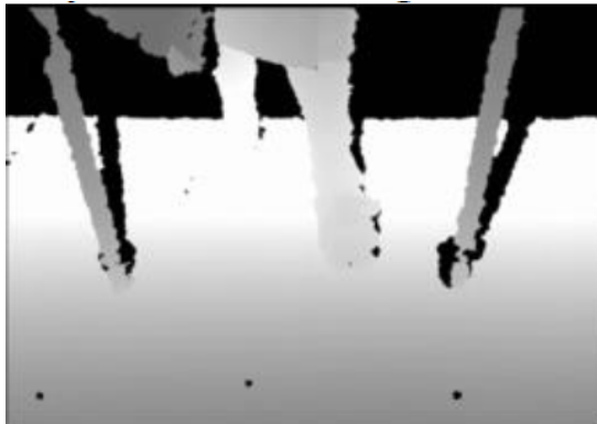
FIGURE 3.3 – Exemple de carte de profondeur : le niveau de gris de chaque pixel est une image de la profondeur
