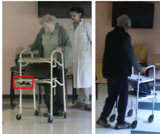
FIGURE 3.13 – Deux sujets âgés utilisant un déambulateur omnidirectionnel passif avec la caméra de profondeur embarquée
