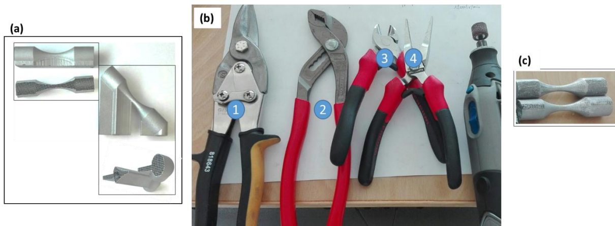
Figure II-29 : Schématisation du protocole de suppression des supports de construction. (a) Br- EOS-Bar-XY et Br-EOS-Bar-alpha45 avec supports, (b) outillage mis en jeu pour la suppression des supports, (c) éprouvettes avant usinage des filets.
