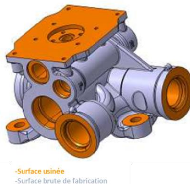
Figure I-42 : Vue 3D d'une servovalve [Zodiac Hydraulics], données CAO avant fabrication additive.
