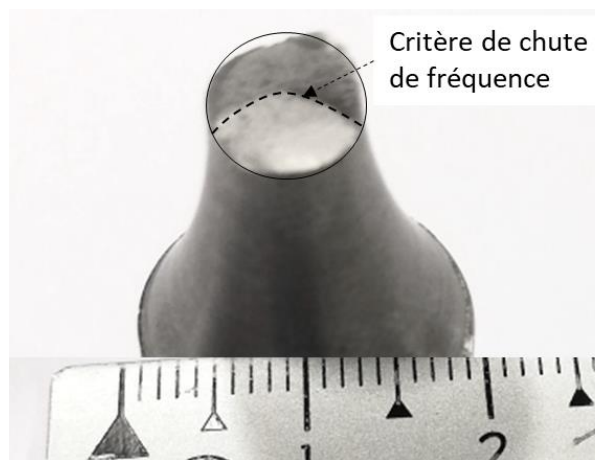
Figure II-30 : Vue macroscopique d'un faciès de rupture d'une éprouvette de type C2 de la référence Us-EOS-Bar-XY.
