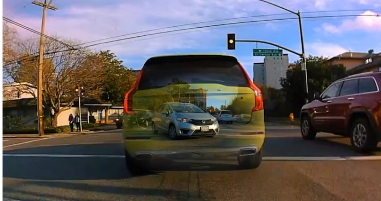
FIGURE 4 : Illustration du système Xtravue proposé par Valeo.
