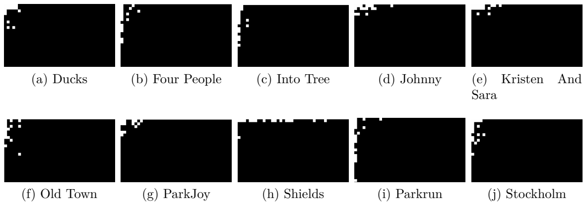
FIGURE 4.8 : Représentation visuelle de la localisation des 16 SFC (petits carrés blancs) sélectionnés par OPA-SoftCast dans le chunk supérieur gauche (taille 160 \times 90 ) du premier plan DCT-3D pour les séquences vidéo HD720p sélectionnées. Seule la partie supérieure gauche ( 40 \times 22 ) de chaque chunk est affichée pour faciliter la visualisation.
