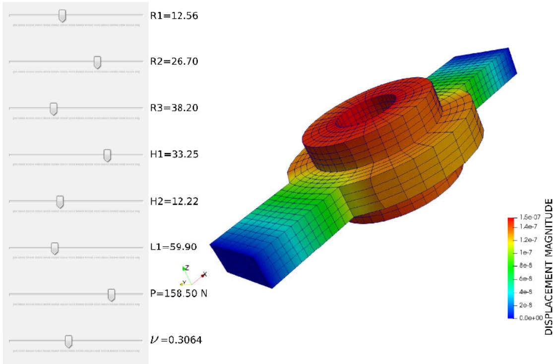
**Figure 11:** Évaluation du modèle réduit de joint. La base réduite est constituée des 50 premiers modes. 400 snapshots ont été nécessaires pour construire ce modèle réduit. La plage des paramètres utilisée est donnée en Tableau 1.
