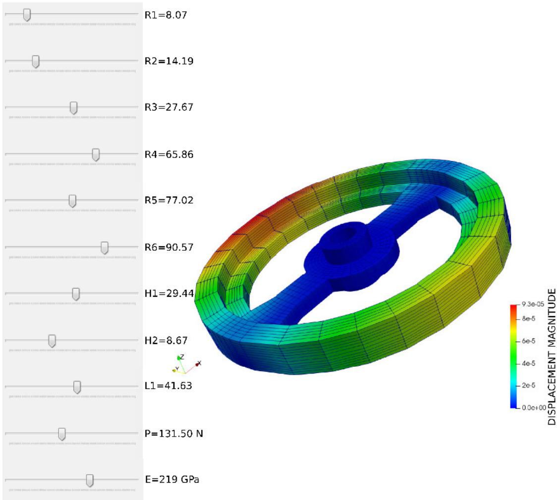
**Figure 12:** Évaluation du modèle réduit de roue. La base réduite est constituée des 50 premiers modes. 592 snapshots ont été nécessaires pour construire ce modèle réduit. La plage des paramètres utilisée est donnée en Tableau 2.
