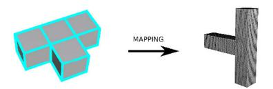
**Figure 9:** Mapping de configuration de cuboïdes. En utilisant les données topologiques et géométriques de la configuration en cuboïdes ainsi que la paramétrisation globale, un maillage en quadrilatères est calculé.
