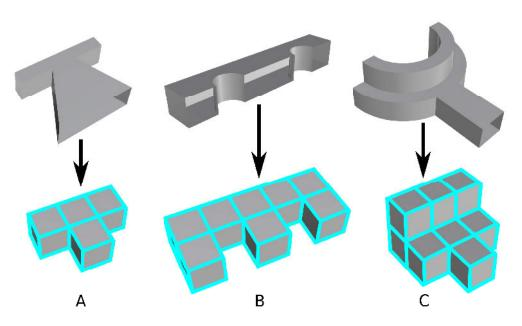
Figure 8: Décomposition en cuboïdes. Pour chaque géométrie de pantalon, une configuration en cuboïdes est optimale pour comprendre ces caractéristiques géométriques. (A) La plus simple des configurations en cuboïdes pour un pantalon. (B) Une configuration avec 8 cuboïdes. (C) Une configuration avec 10 cuboïdes.
