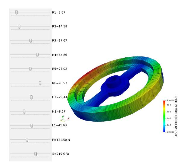
**Figure 12:** Évaluation du modèle réduit de roue. La base réduite est constituée des 50 premiers modes. 592 snapshots ont été nécessaires pour construire ce modèle réduit. La plage des paramètres utilisée est donnée en Tableau 2.
