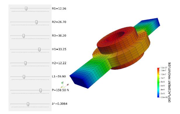
Figure 11: Évaluation du modèle réduit de joint. La base réduite est constituée des 50 premiers modes. 400 snapshots ont été nécessaires pour construire ce modèle réduit. La plage des paramètres utilisée est donnée en Tableau 1.
