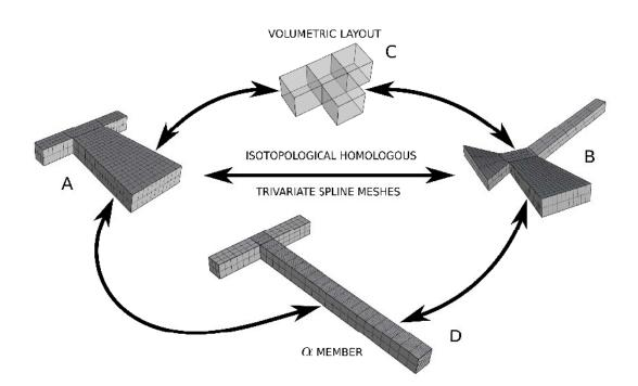
**Figure 10:** Construction de maillages isotopologiques pour des applications de modèles réduits à paramètres géométriques. (A) Géométrie A d'un volume formé de B-Splines. (B) Géométrie B d'un volume formé de B-Splines. (C) Structure volumique de référence. (D) Membre- $\alpha$  choisi pour représenter la population de géométries à étudier.
