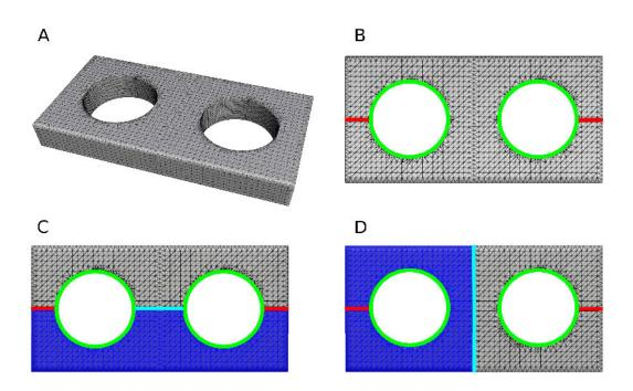
**Figure 7:** Décomposition en pantalons. (A) Maillage triangulé issu de la CAO. (B) Handle et tunnel loops calculées en utilisant des critères géométriques (les handle loops en rouge, les tunnel loops en vert). (C) Segmentation en pantalon utilisant le critère géométrique de la boucle de découpage la plus courte. (D) Segmentation en pantalon utilisant un critère de symétrie.
