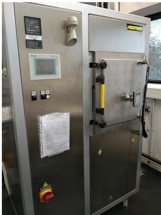
Figure II-12 : Four graphite pour les traitements hautes températures
