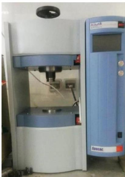
Figure II-10 : Presse uniaxiale utilisée entre 4T et 40T
