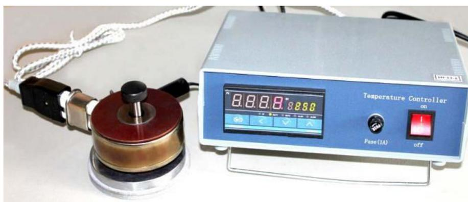
Figure II-9 : Moule chauffant de pressage et son contrôleur de température
