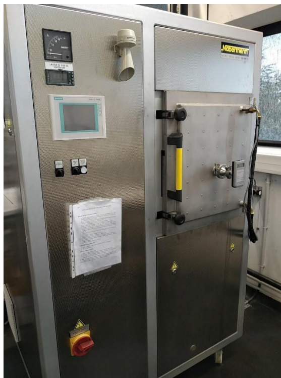
Figure II-12 : Four graphite pour les traitements hautes températures
