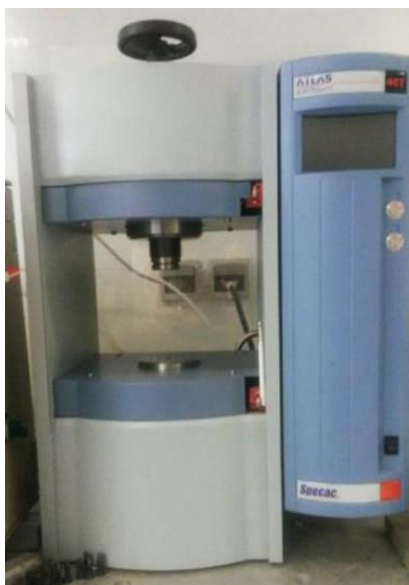
Figure II-10 : Presse uniaxiale utilisée entre 4T et 40T
