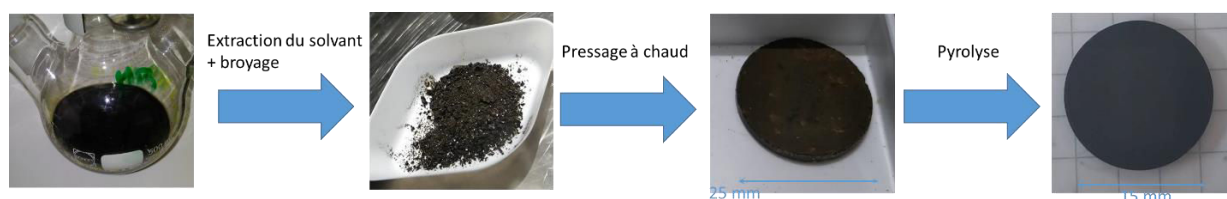
Figure V-2 : Processus d'élaboration de pièces massives par pressage de polymères précéramiques
