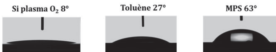
Figure 11: Mesure de l'angle de goutte pour différents échantillons de silicium.
