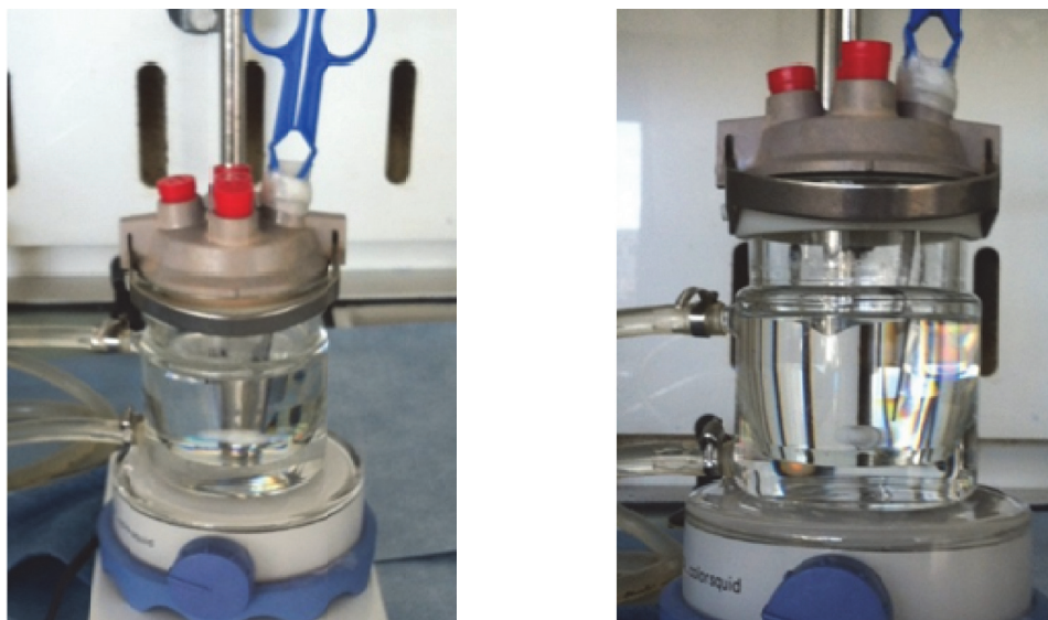
Figure 9: Photos du réacteur employé pour la fonctionnalisation des échantillons de silicium.
