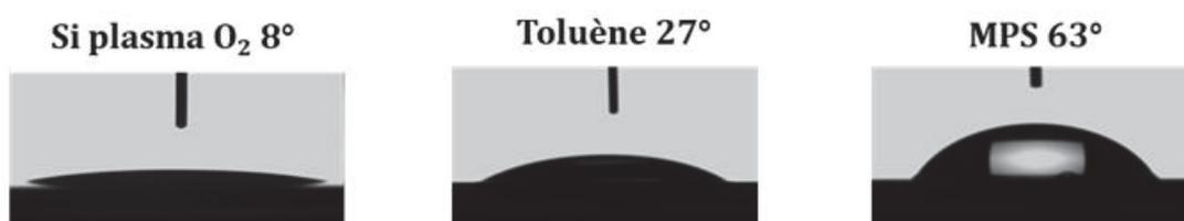
**Figure 11:** Mesure de l'angle de goutte pour différents échantillons de silicium.
