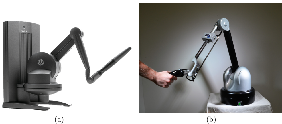
FIGURE 1.6 – (a) : l'interface haptique Touch X de 3D Systems, (b) : l'interface haptique Virtuose 6D de Haption
