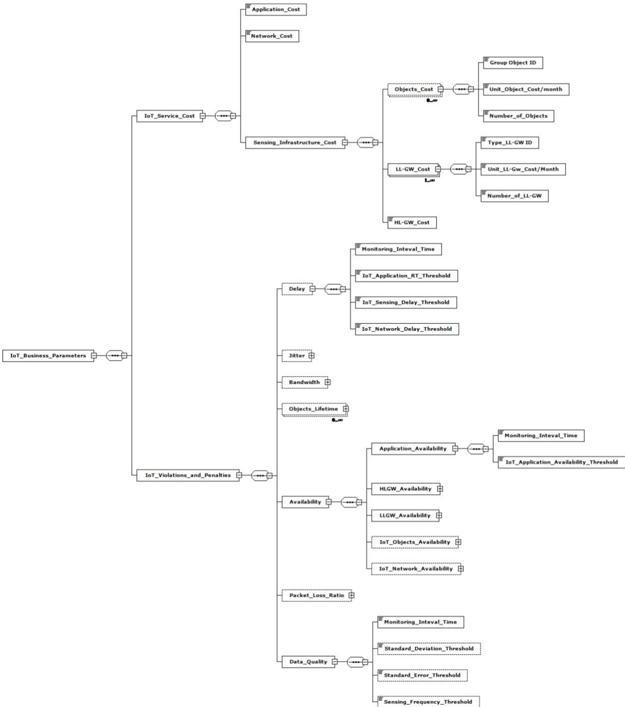
Figure 4.26 : Représentation du schéma XML des paramètres commerciaux de l'iSLA
