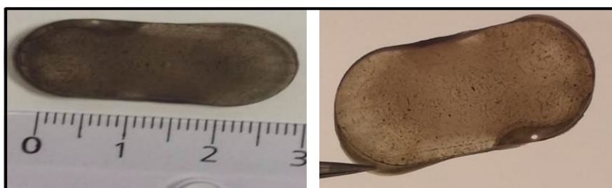
Figure 3 : Membrane composite Nafion + 5wt% CS-SO 3 H pr par e par la m thode de « coul e- vaporation ».
