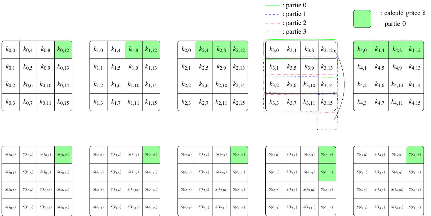
FIGURE 1.6 – Les 4 parties et octets de clé de tour et valeurs de Sbox calculées grâce à la partie 0
