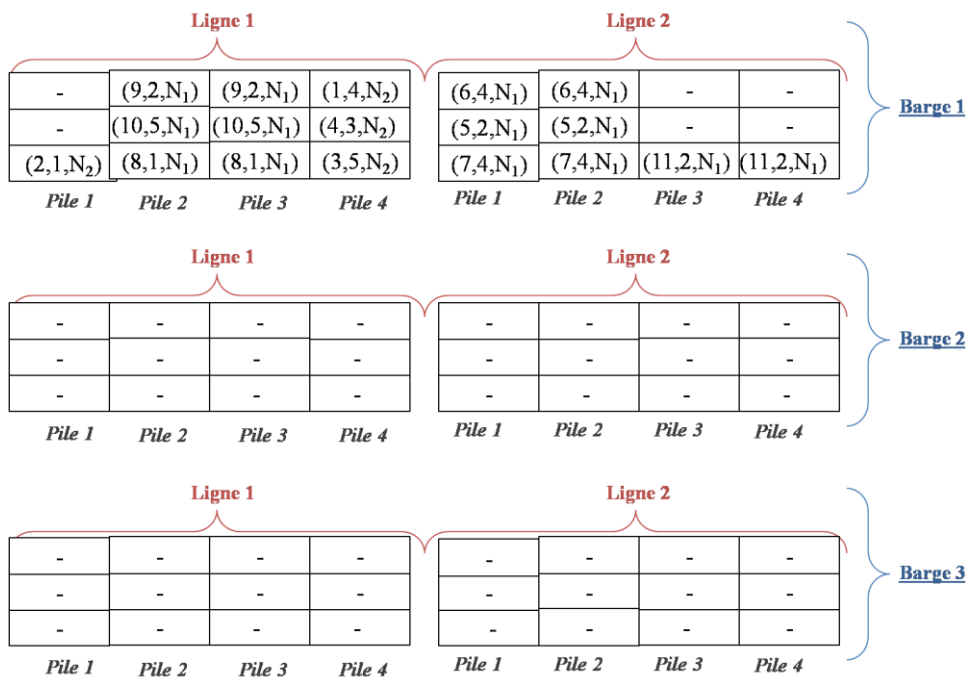
Figure IV-6. Le plan de chargement obtenu lorsque seul le nombre de barges réellement utilisées est minimisé
