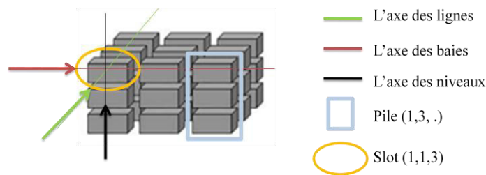
Figure III-4. Illustration des slots de la barge
