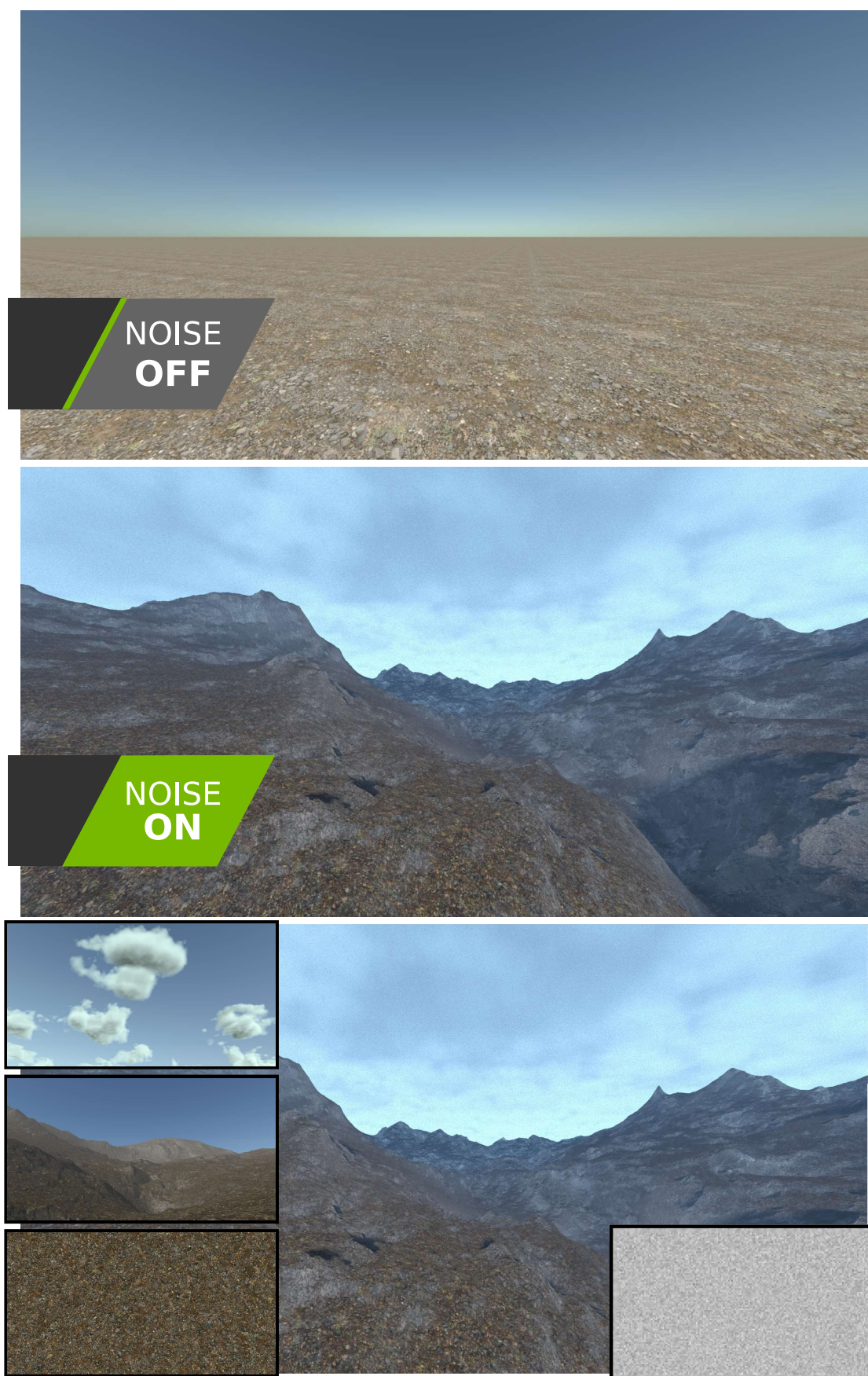
FIGURE 1.2 – La modélisation de phénomènes non structurés (reliefs d’une montagne, forme d’un nuage, grain de pellicule, la texture recouvrant le sol, etc.) par des fonctions de bruit procédurales permettent de passer d’une image toute simple (en haut) à une image présentant toute une variété de détails, le tout calculé à la volée.
